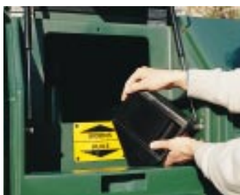
Vidage de l'huile usagée et dépôt du bidon vide.
